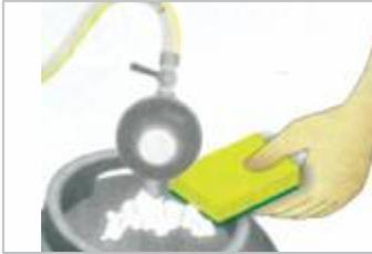
A cada troca de botijão, faça o teste da espuma: aplique uma esponja embebida em água e sabão na conexão entre o regulador e o botijão. Havendo vazamento, aparecerão bolhas no local.
